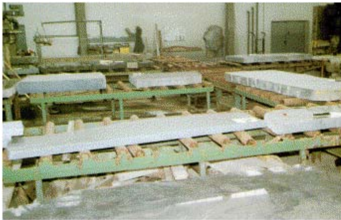
Abb. 22: Rollenbahnen für Zwischentransporte
