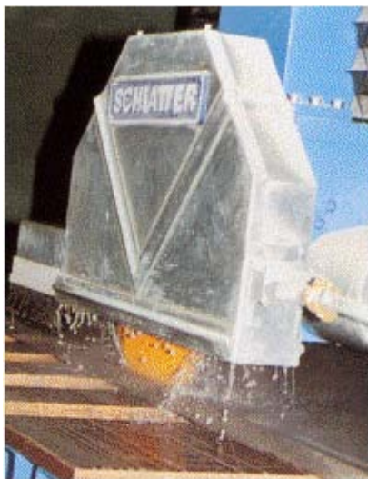
Abb. 36: Schutzhaube und Spritzschutz an einer Brückensäge
