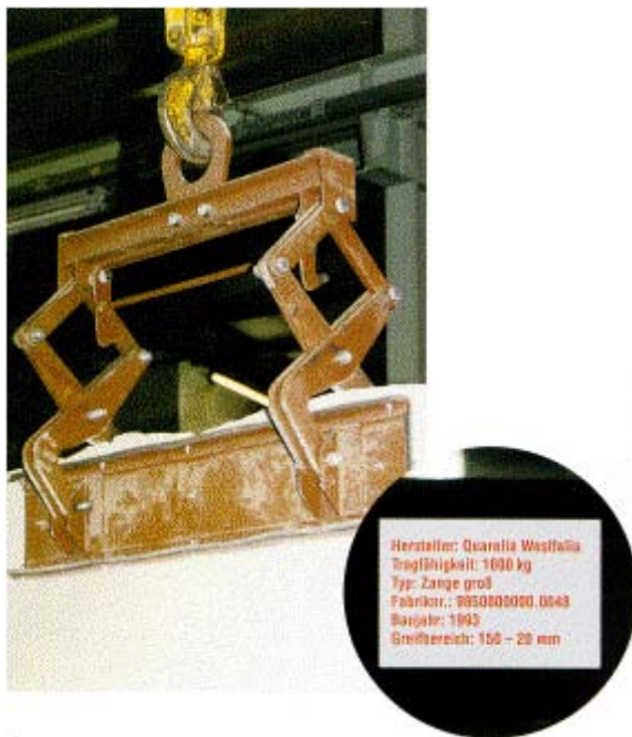
Abb. 14: Plattenzange mit Kennzeichnung
