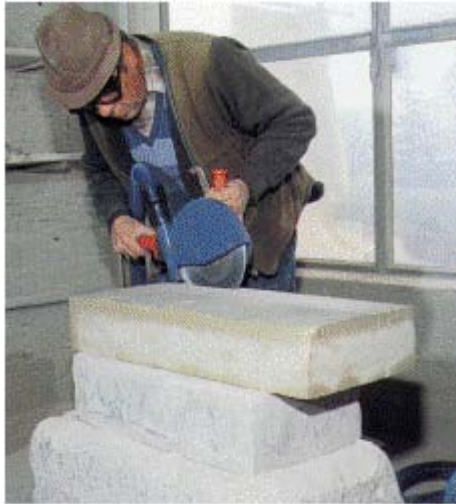
Abb. 30: Trennscheibe mit Absaugeinrichtung
