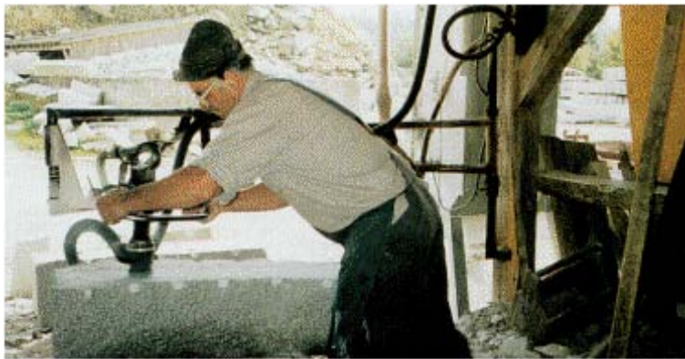
Abb. 23: Staubabsaugung direkt an der Bearbeitungsstelle
