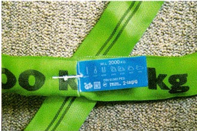
Abb. 19: Tragfähigkeitsangabe an Hebebändern durch eingenähtes Etikett
