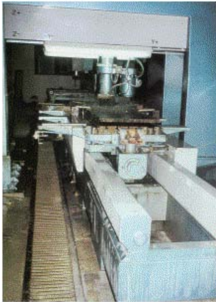
Abb. 6: Trittsicher abgedeckte Wassersammelrinne
