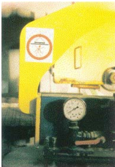
Abb. 17: Vacuumheber mit Druckanzeige und Warnhinweis
