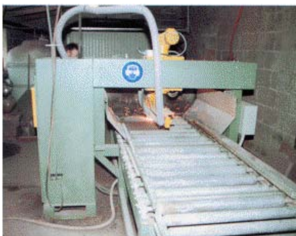
Abb. 38: Flämmanlage zur Oberflächenbearbeitung
