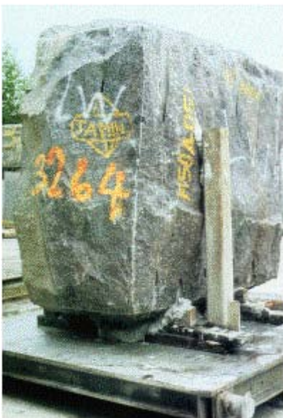
Abb. 8: Blockwagen mit Rungen
