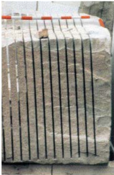
Abb. 9: Mit Haltebügel gesicherte Steinplatten
