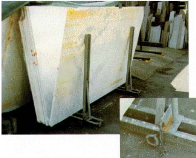
Abb. 15: Hilfsstützen am A-Bock-Lager
