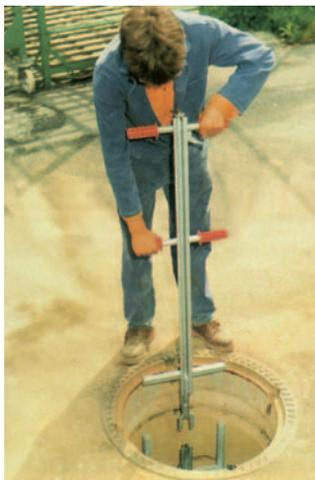
**Bild 10:** Stationäre Haltevorrichtung
