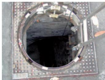
**Bild 11:** Mobile Haltevorrichtung
